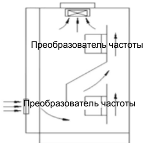
Рис. 3-2. Установка двух и более преобразователей частоты
