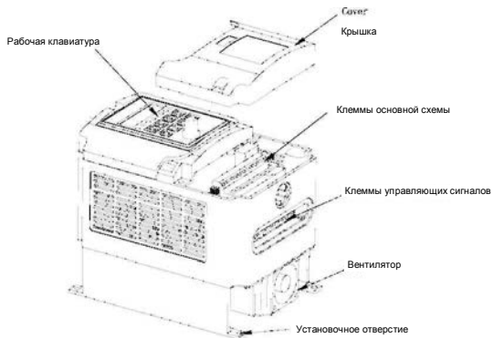
Рис. 2-1. Наименование компонентов преобразователей частоты мощностью 0,75 кВт – 18,5 кВт
