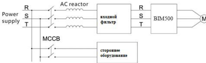
Рисунок 3-24 Схема подключения фильтра помех со стороны источника питания
