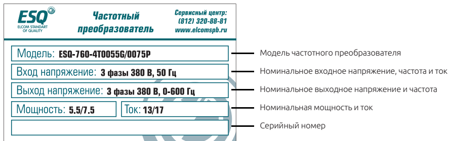
Рисунок 2-4. Изображение шильды частотного преобразователя ESQ-760
