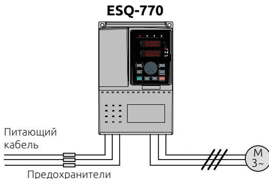
Рисунок 3-30. Схема установки предохранителей.
