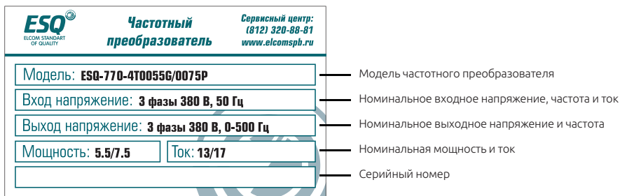
Рисунок 2-4. Изображение шильды частотного преобразователя ESQ-770
